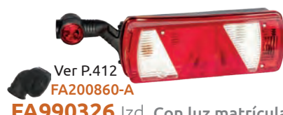
FA990327 Dch. Con luz matrícula y retroalarma
