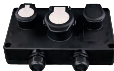
VER PÁGINA 431 Set de tomas R48 Con electrónica para intermitencia lateral y cableados de instalación 15 polos | (ISO 12098) Tipo N | (ISO 1185) Tipo S | (ISO 3731)
