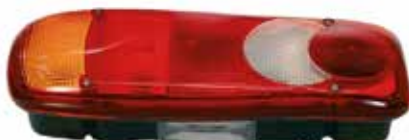
VG152170 Izd. con luz matrícula con catadióptrico
