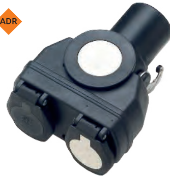
FA200159 Adaptador 15 polos | (ISO 12098) Tipo N | (ISO 1185) Tipo S | (ISO 3731)
